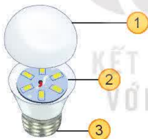
Hình 11.5. Cấu tạo của bóng đèn LED búp
